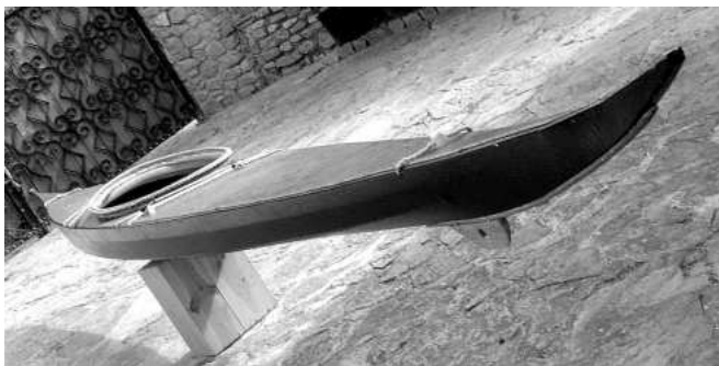
Photo 2 : Kayak groenlandais (construction actuelle), équipé de sa dérive fixe ajourée
